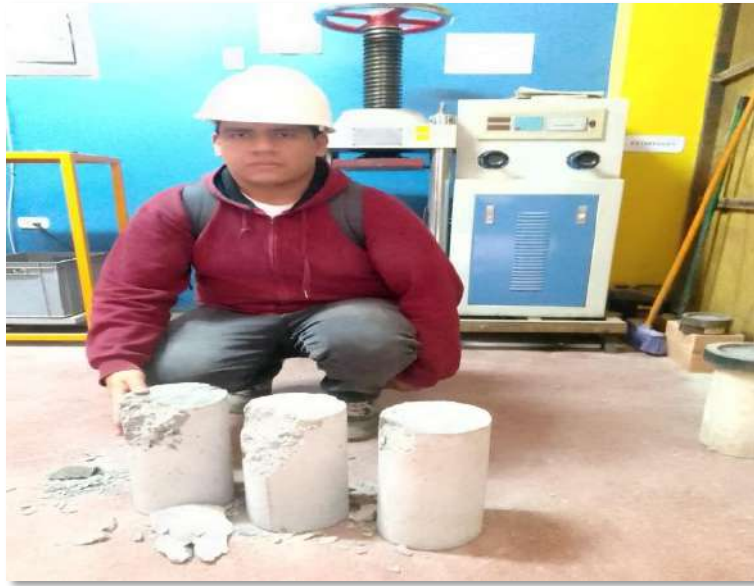
Figura 39. Fallas provocadas por el ensayo de rotura.
