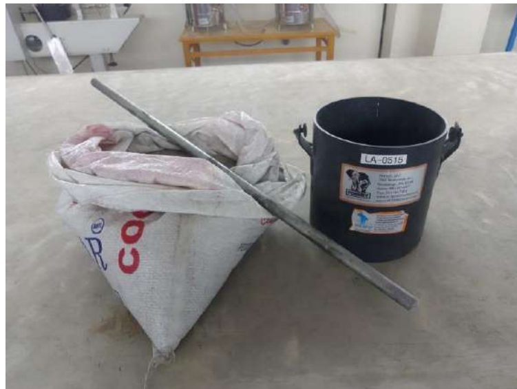
Figura 18. Materiales para ensayo Peso Unitario Compactado del agregado fino.
