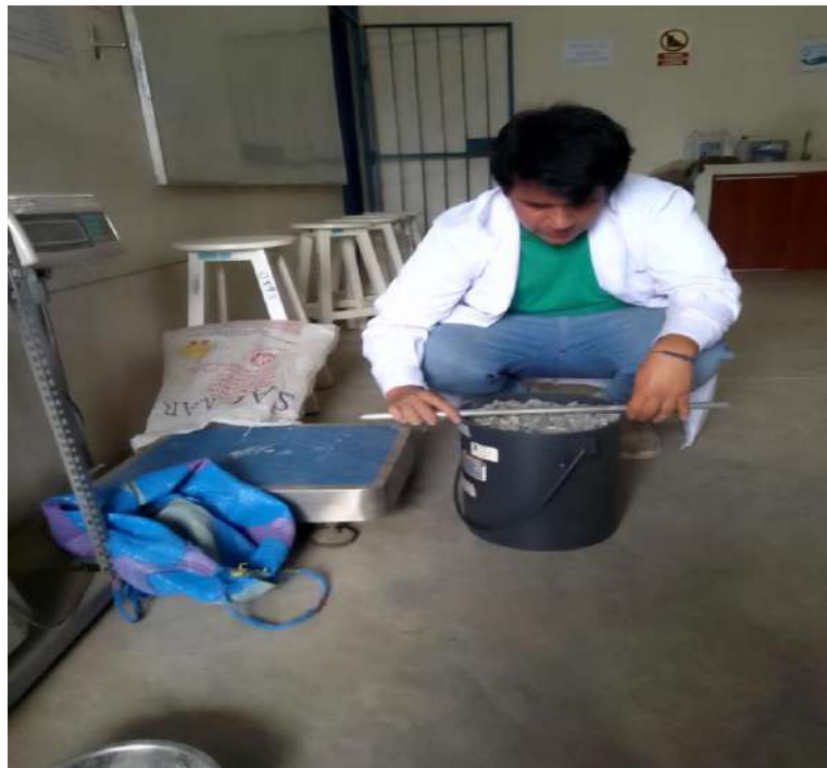
Figura 23. Compactado manual de 25 golpes.
