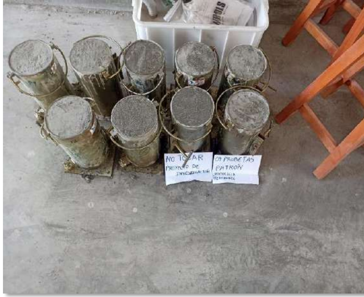
Figura 37. Una cantidad de 9 probetas con mezcla de concreto.
