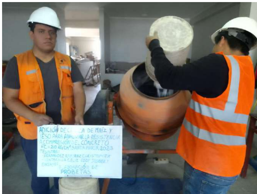
Figura 32. Introduciendo el yeso en el trompo.
