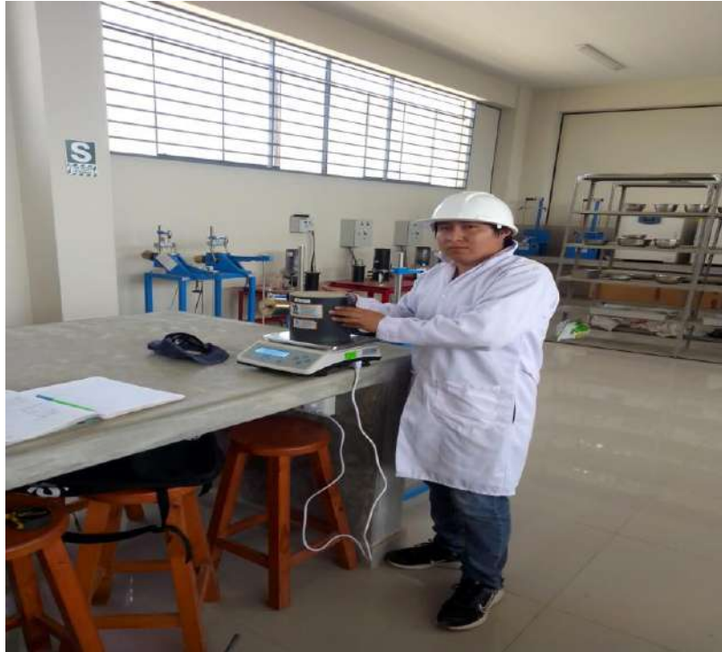
Figura 21. Peso de la primera muestra obtenida del ensayo Peso Unitario Compactado.
