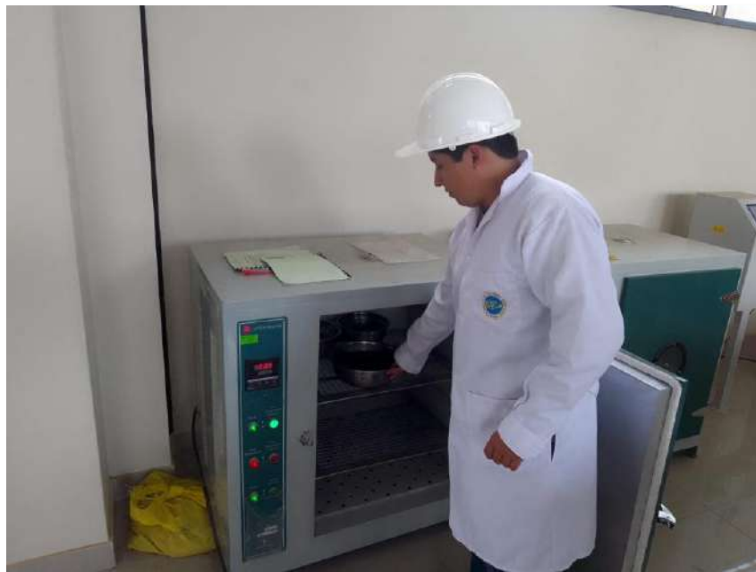
Figura 28. Colocación de la muestra de agregado del agregado grueso en el horno
