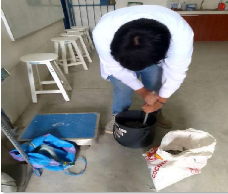
Figura 23. Compactado manual de 25 golpes.
