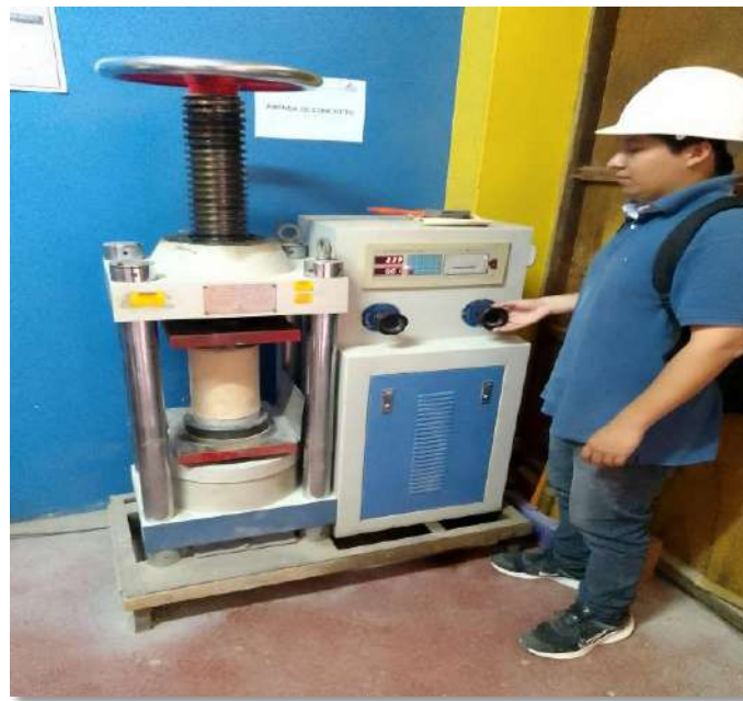
Figura 38. Ensayo de rotura de probeta.
