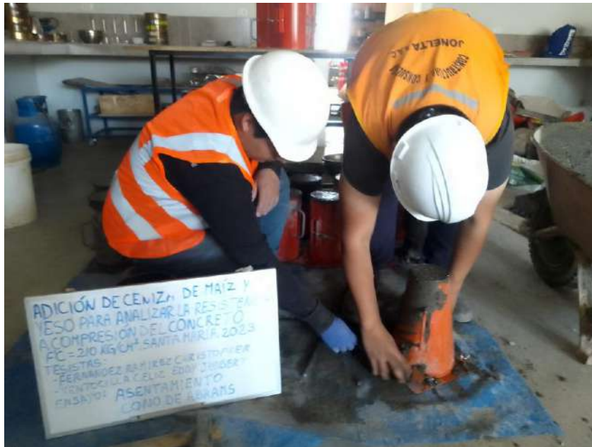
Figura 35. Ensayo de asentamiento.
