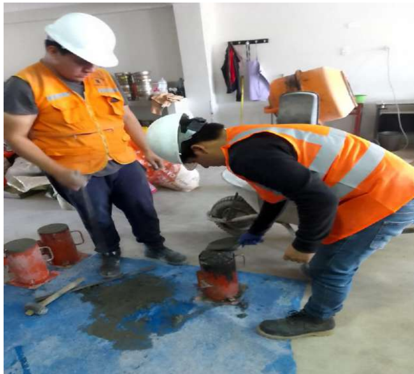
Figura 34. Llenado de la última capa de la probeta.
