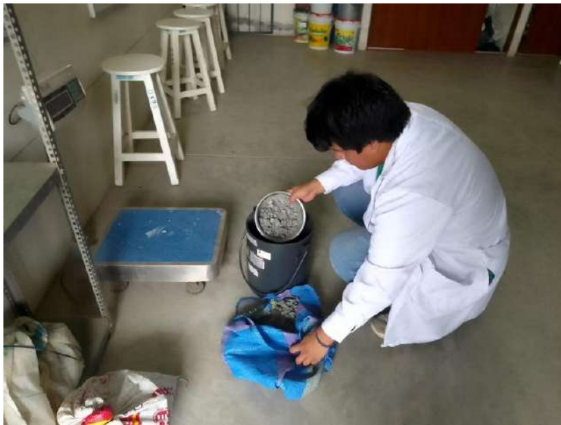
Figura 22. Colocación del agregado grueso en el recipiente mediano.
