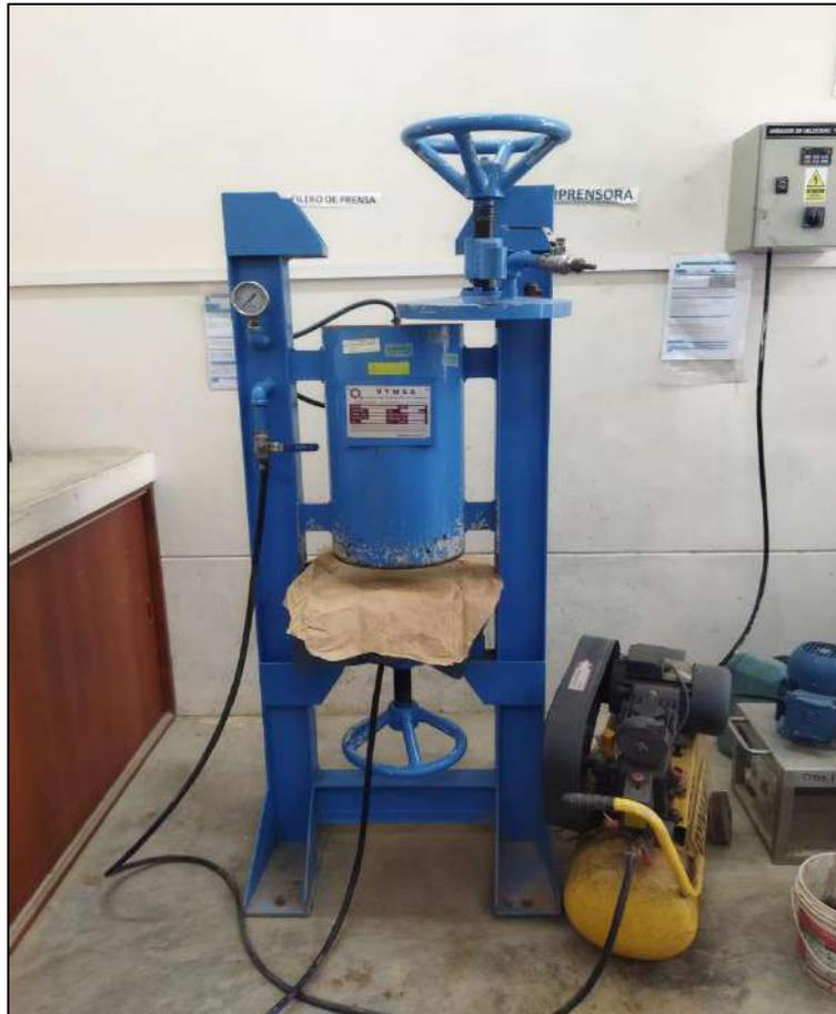
Luego se comienza con el vertido del aceite usado a la máquina por la parte superior se cierra asegurándose que no se escape ninguna fuga para que la presión no se escape y perjudique el proceso.
