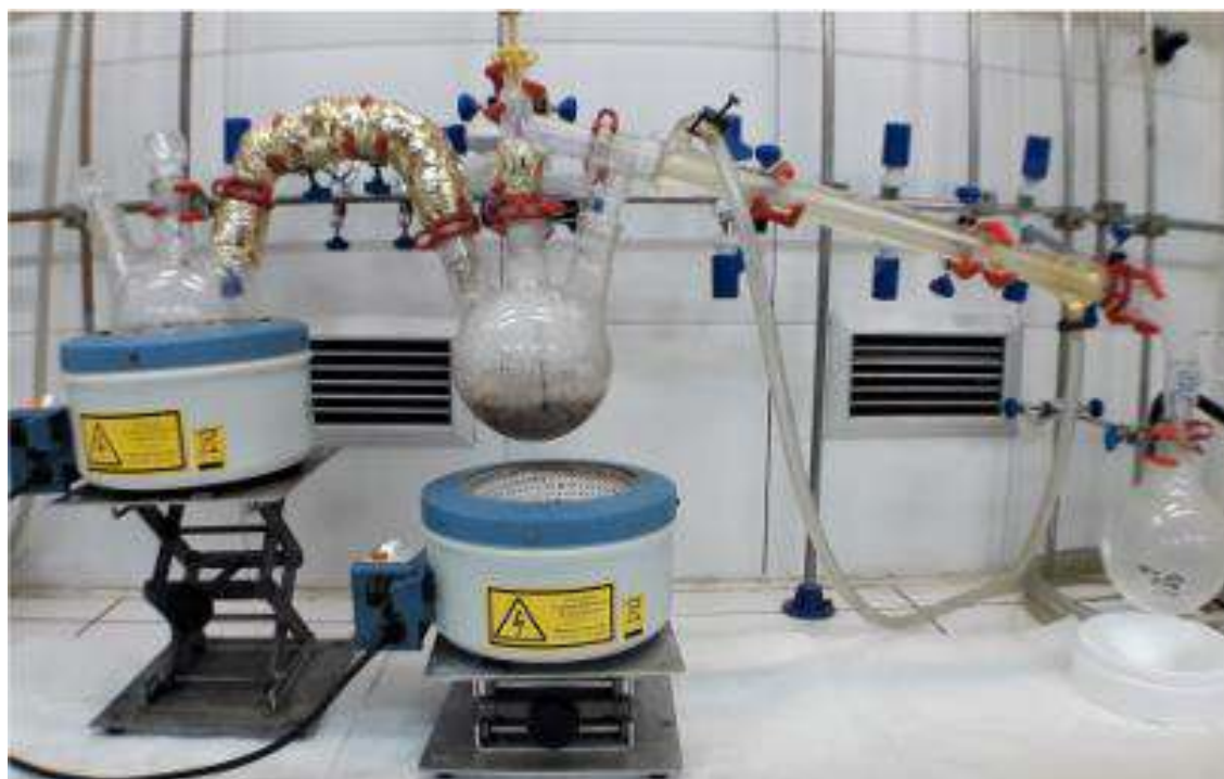
Figura 8. Montaje de Equipo de Extracción por Destilación por Arrastre a Vapor
