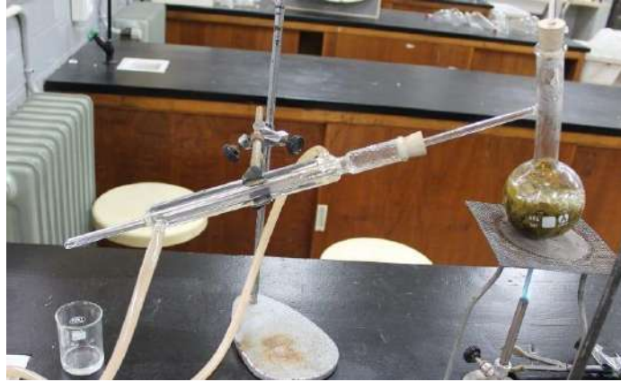
Figura 6. Montaje de Equipo de Hidrodestilación
