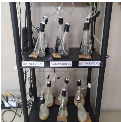
Ensamblado y funcionamiento del sistema de biorreactores de inmersión temporal neumática
