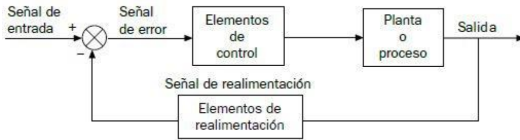
Figura 1. Sistema de control lazo cerrado
