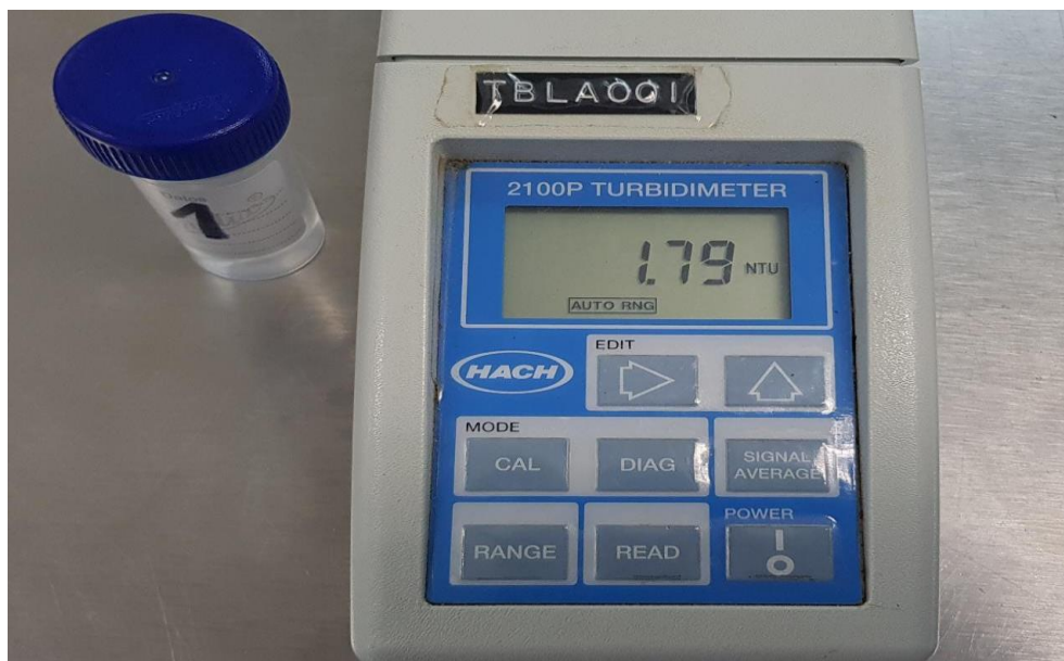
Figura 24 Turbidez de agua tratada con penca de tuna (post análisis)
