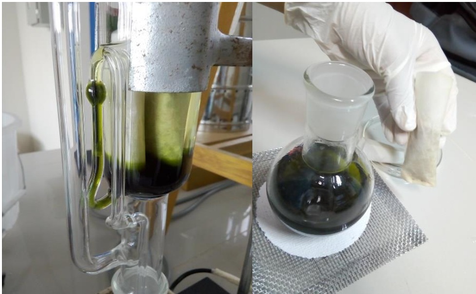
Figura 18 extracción de pigmentos con equipo soxhlet
