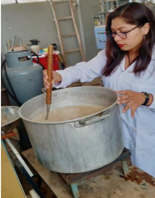
Figura Nro. 20. Macerado de la malta. Remojo entre 60-65 °C, por una hora y 30 minutos, para la hidratación y gelatinización de los almidones de la malta, (Lautering).
