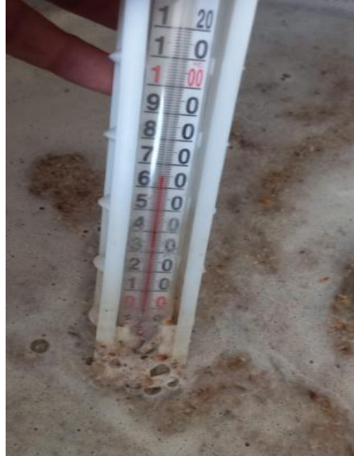
Figura Nro. 20. Macerado de la malta. Remojo entre 60-65 °C, por una hora y 30 minutos, para la hidratación y gelatinización de los almidones de la malta, (Lautering).
