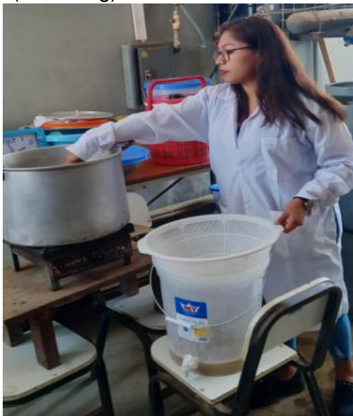
Figura Nro. 21. Separación del extracto acuoso, llamado mosto dulce, de los sólidos agotados, lavando con agua caliente sobre los sólidos restantes de la malta. (Lautering).
