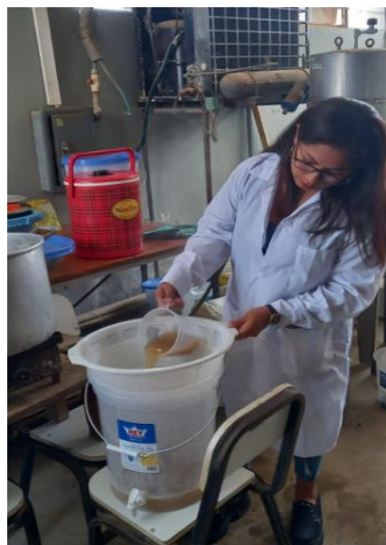
Figura Nro. 21. Separación del extracto acuoso, llamado mosto dulce, de los sólidos agotados, lavando con agua caliente sobre los sólidos restantes de la malta. (Lautering).
