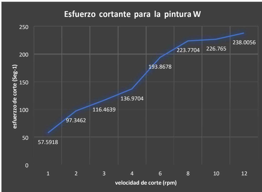
Figura 15. Esfuerzo de corte respecto a la velocidad de corte
