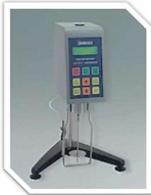
*Figura 5. Viscosímetro de Brookfield*
