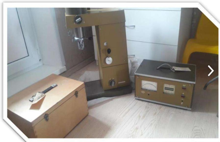
Figura 8. Viscosímetro RHEOTEST Messgeräte Medingen Series RHEOTEST RN
