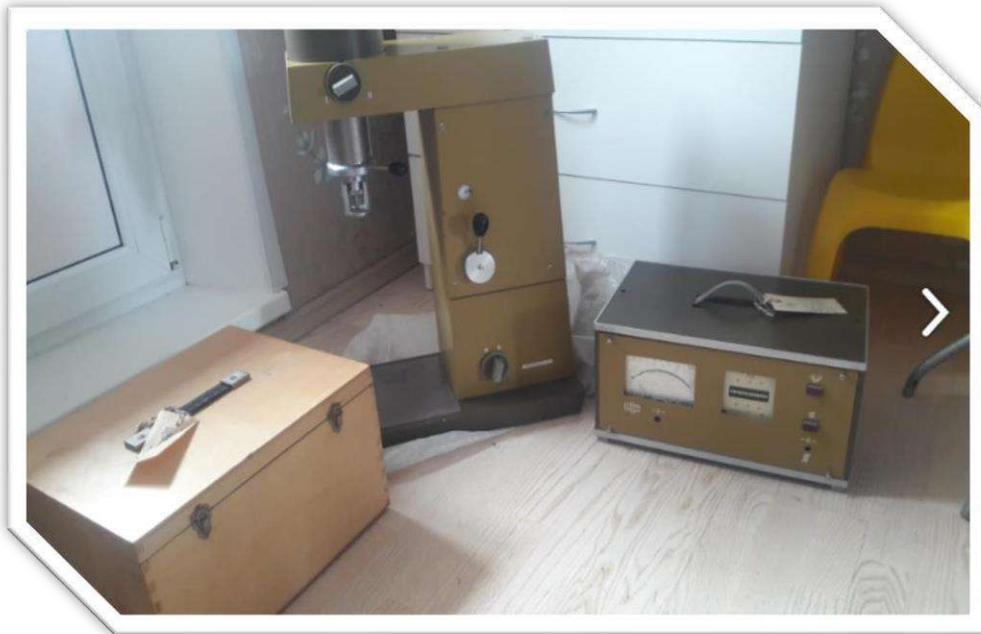
Figura 10. Viscosímetro RHEOTEST Messgeräte Medingen Series RHEOTESTE R
