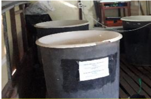
Figura N° 2 Tanques circulares de fibra de vidrio utilizados en la investigación
