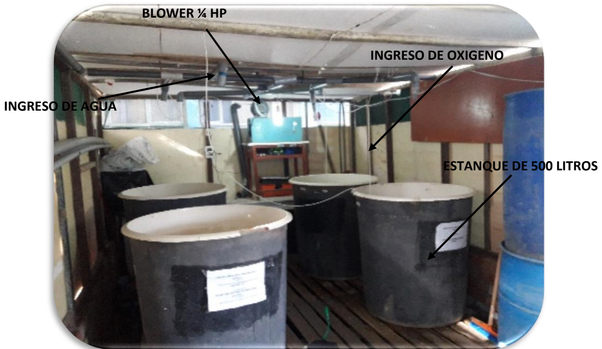
Figura N° 1. Tanques circulares de fibra de vidrio.
