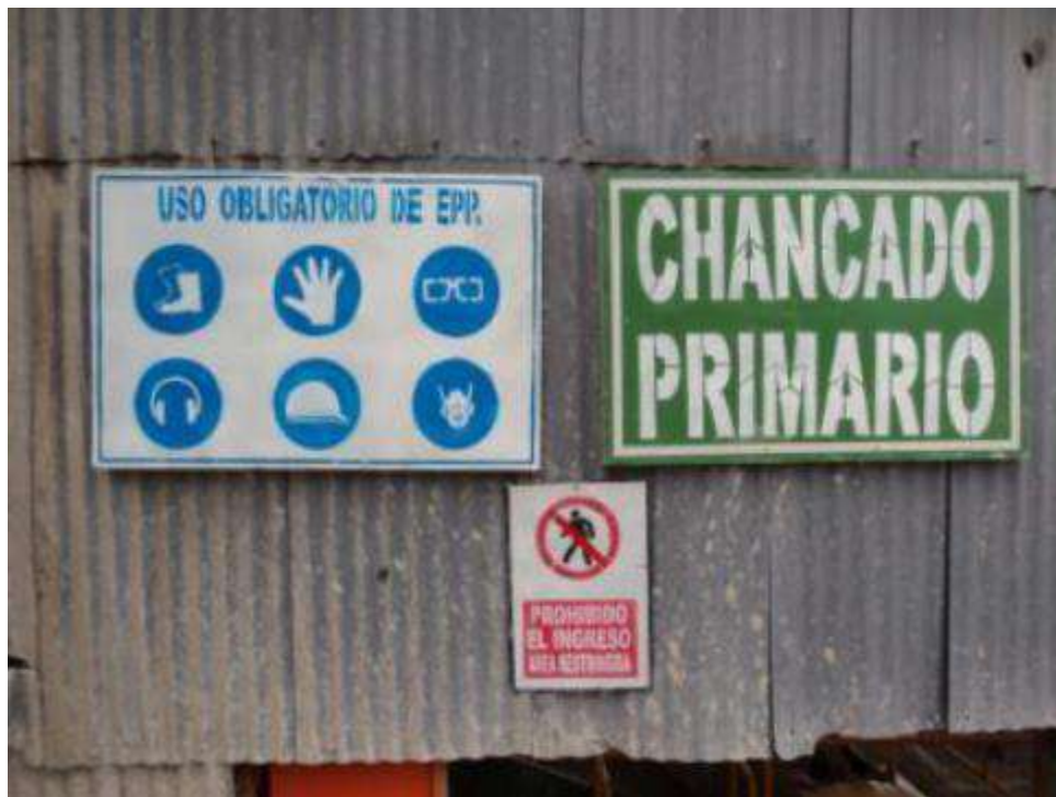
Foto N° 4: Señales obligatoriedad, informativas y restrictivas ubicadas al acceso a la zona de chancado primario, de acuerdo al código de colores anexo N° 11
