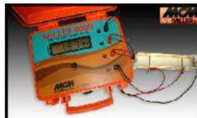
Figura 29: Equipo instrumental Georesistivímetro Grm y accesorios
