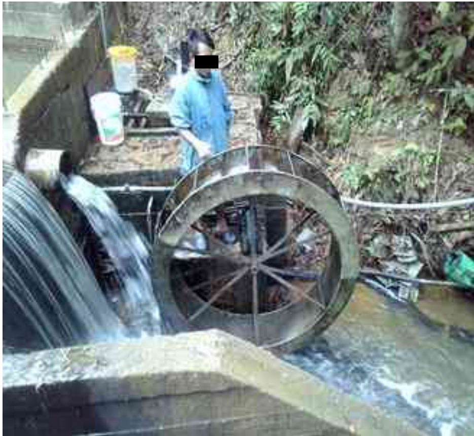
Figura 16: dimensiones de la rueda Pelton, diámetro exterior 1.75m
