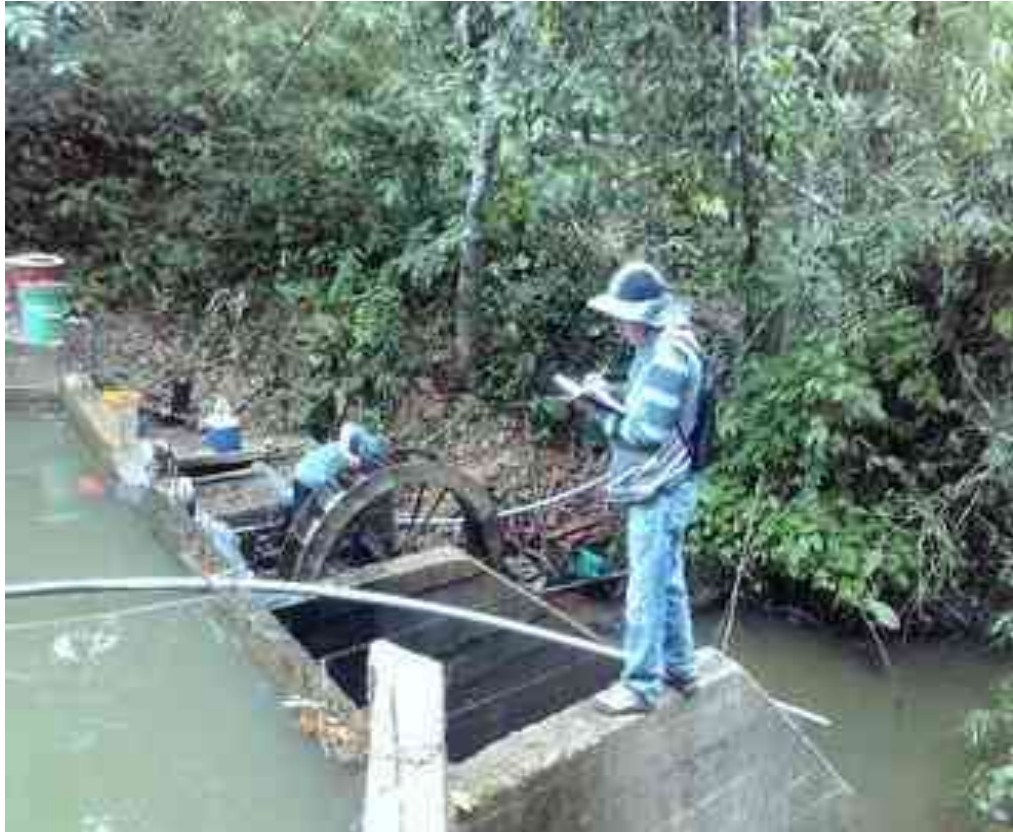
Figura 17: rueda Pelton, el cual gira por la fuerza hidráulica y a su vez hace accionar a la bomba.
