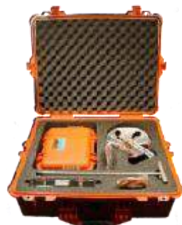
Figura 29: Equipo instrumental Georesistivímetro Grm y accesorios
