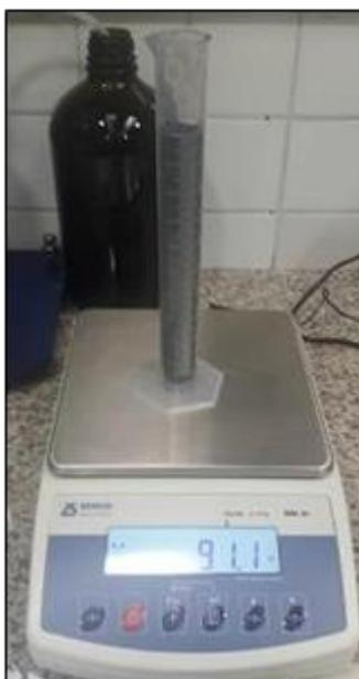
Ilustración 38. Pesado de Probeta más muestras
