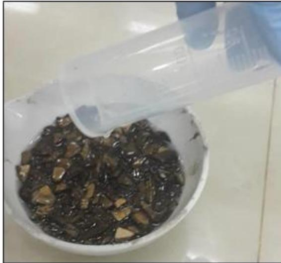
Ilustración 12. Activación empleando ácido fosfórico
