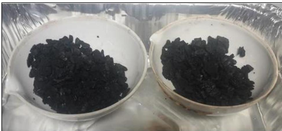
Ilustración 5. Carbón activado seco
