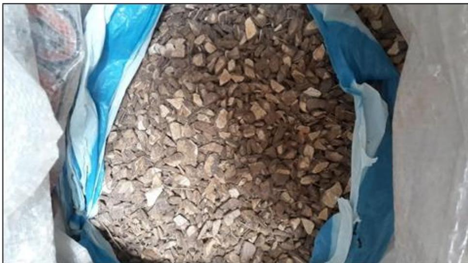
Ilustración 22. Posterior a criba de 3/8
