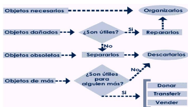
Figura 2. Diagrama de flujo de Clasificación
