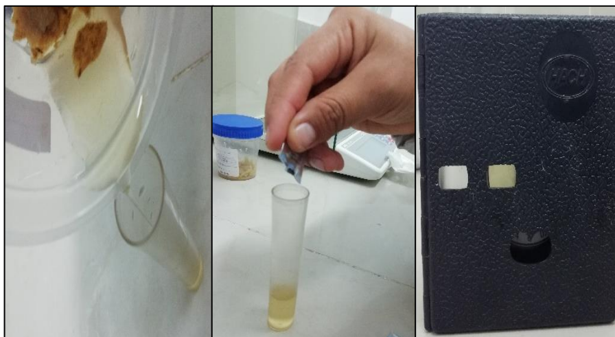
Figura 34. Determinación de cloro de cáscara. Fuente: Elaboración propia
