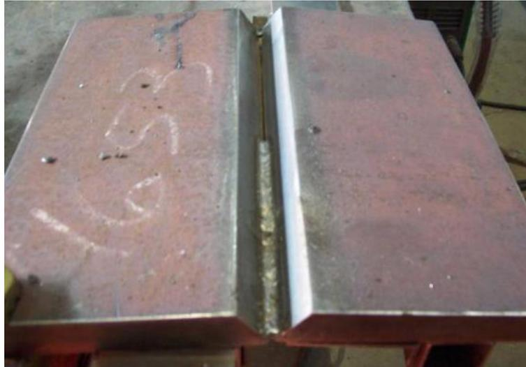
*Figura 13.* Verificación del pase de raíz.
