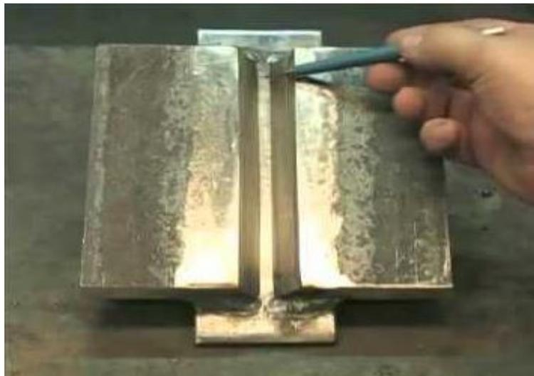
*Figura 12.* Verificación de preparación de junta.
