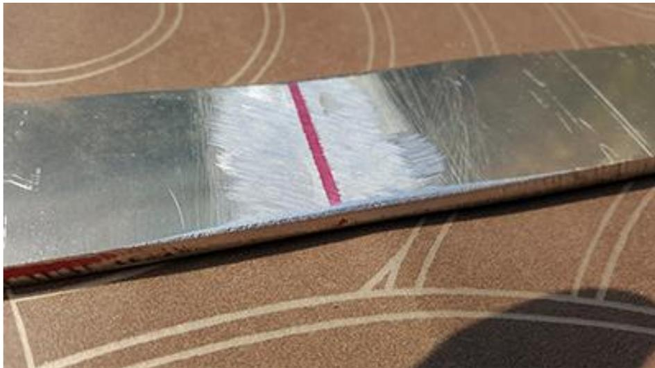
*Figura 14.* Probeta para ensayo de dobléz.
