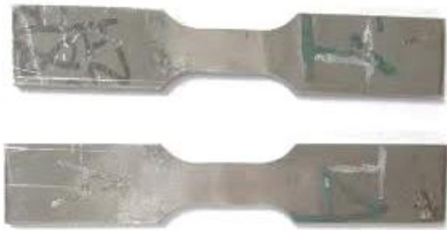
*Figura 17.* Probetas para ensayo de tracción.
