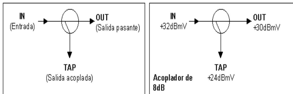
Figura 23: Esquema del acoplador
