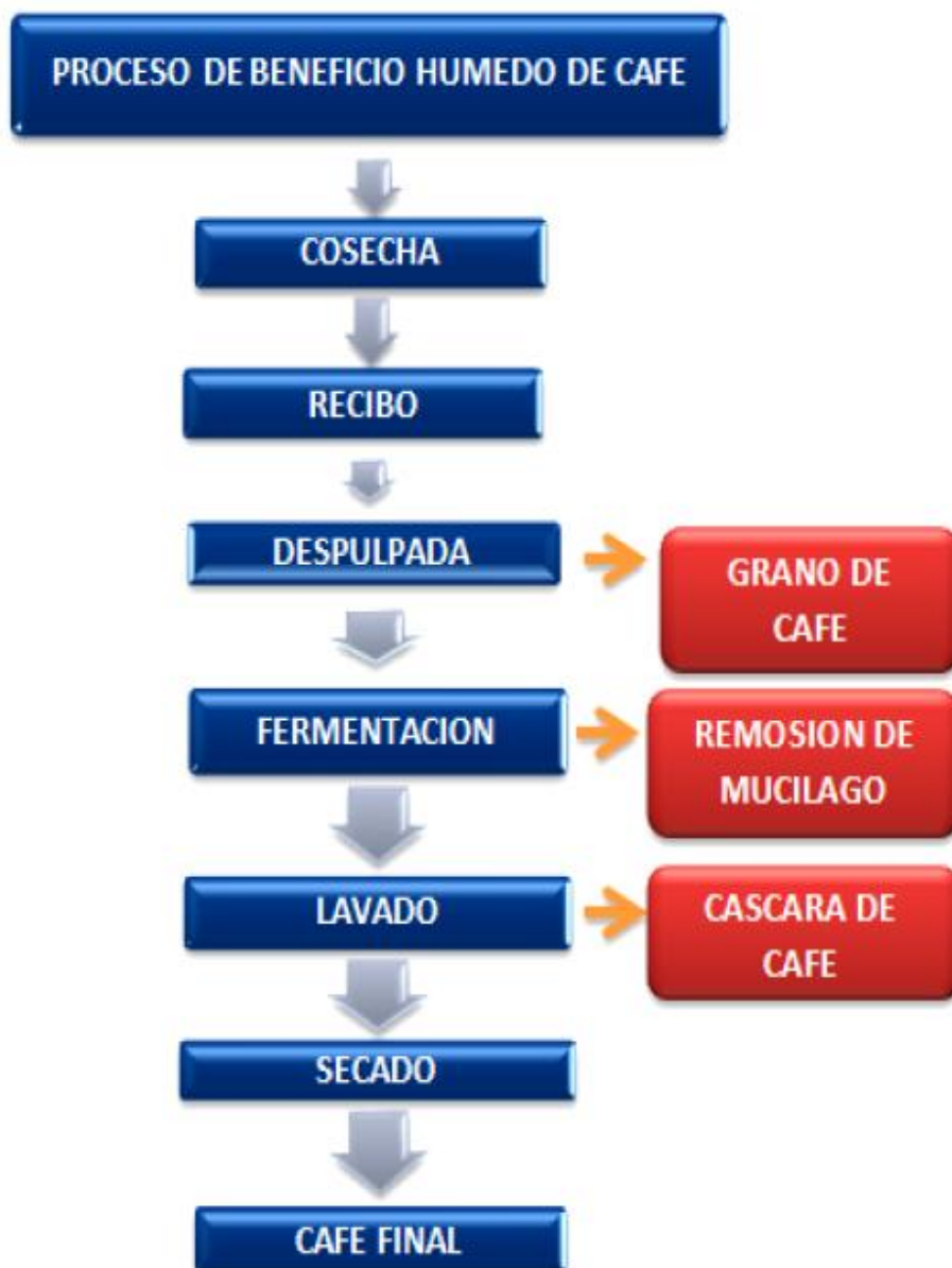
Figura 5. Diagrama de Flujo Beneficio Húmedo de café. Tomado de Urquijo (2016).
